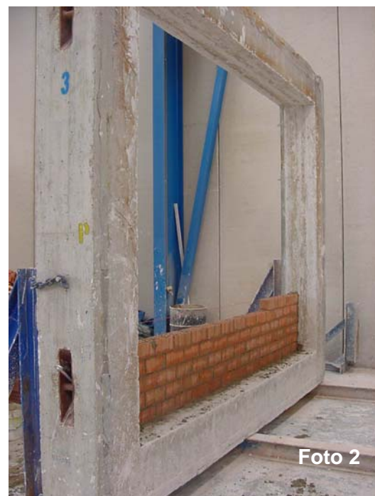
Fotos 1 y 2: Construcción de fábrica de ladrillo perforado cerámico de 11,5 cm
